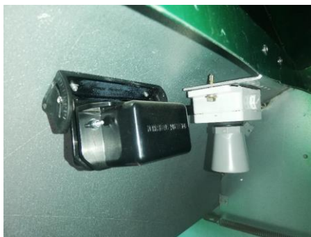
Figur 1 Två olika sensorer under testfasen. En med LiDAR och en med Radar
