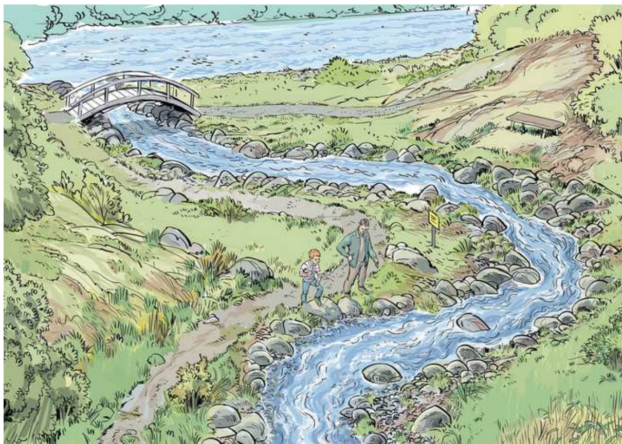
Bild 28. Skissen visar området söder om Picknickudden med dammvallen, utfyllnaden och den naturliknande strömvattenfåran. Illustration Gösta Lindwall.
