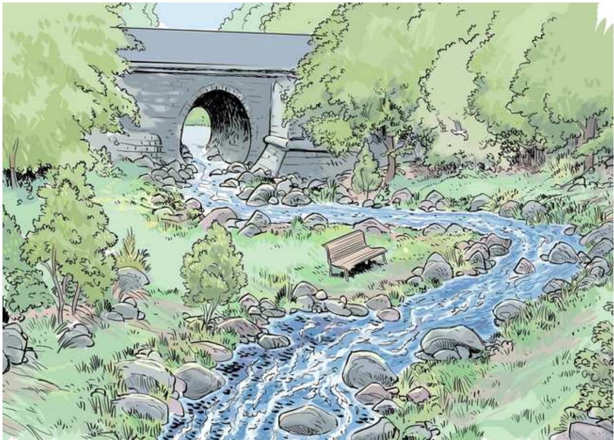
Bild 25. Skissen visar området nedströms järnvägsbron efter att vattennivån sänkts av och den naturliknande strömvattenfåran anlagts. Illustration Gösta Lindwall.
