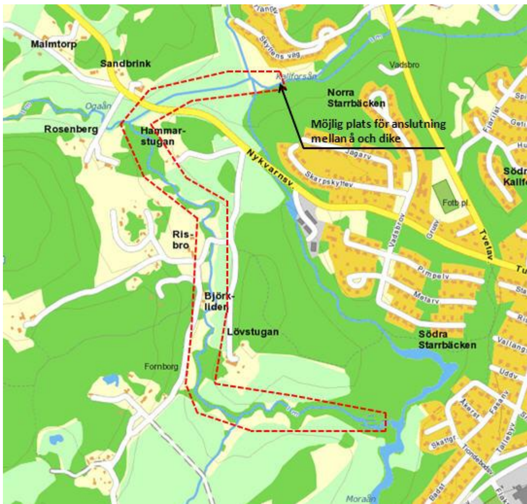
Figur 19. En alternativ vandringsväg förbi Tällebrodammen kan nyttjas genom att skapa en vattenpassage från Kallforsån till diket/bäcken som rinner till Ogaån. Vid anslutningsplatsen som markeras i kartan löper diket mot Ogaån parallellt med Kallforsån en sträcka. Avståndet mellan diket och ån är endast ca 5 m, vilket gör det till en lämplig anslutningsplats.
