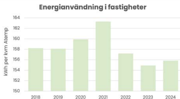
Figur 3. Energianvändning i kommunkoncernens fastighetsbolag per kvadratmeter Atemp (avser normalårskorrigerade värden av el och fjärrvärme baserat på data från Telge Bostäder och Telge Fastigheter). Piken 2021 har att göra med den ökade ventilationen under covidpandemin.
