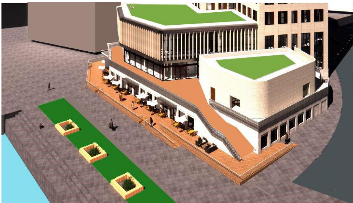
Bild 102: Bild tagen från sydost: uteserveringen kan byggas upp till en färdiggolvshöjd på +2,7 m, entrépartier med sockel byggs om för att anpassas till höjden +2,7 m. Bilden visar också hur uteserveringens golv kan ta upp nivåskillnaden mellan stadens högre nivå vid Ekdalsgatan och kajplatsen.
