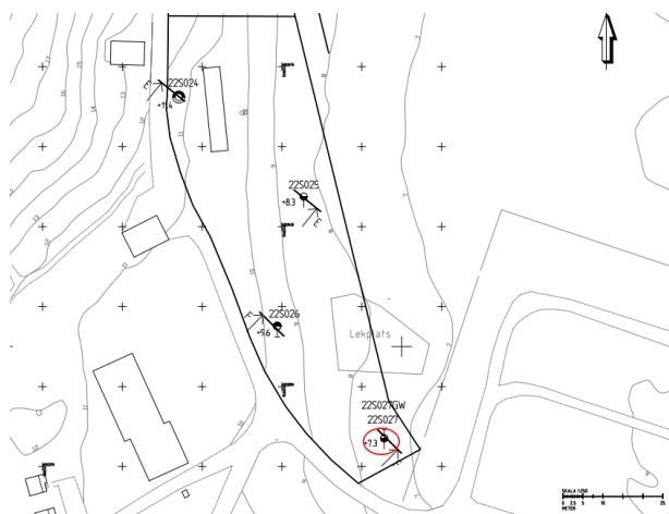
Ritning av mätpunkt 22S027GW markerat i rött, som har en grundvattennivå på 0,2-0,3 meter under markytan.
