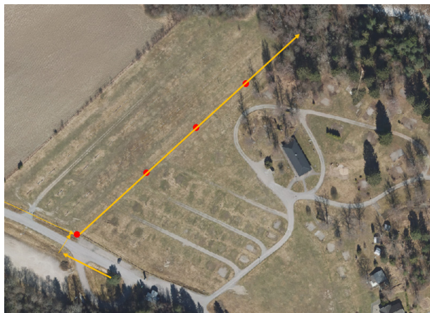
Befintlig dagvattenhantering ovan, diken med trummor och ledning med fyra brunnar markerat i rött.
