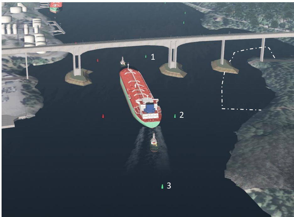
Figur 18. Simulatorflygbild av 200-meters tankfartyg som passerar DP-orådet och Igelstabron söderifrån med två bogserbåtar kopplade. (Storlek och lokalisering av aktuellt DP-område ungefärligt indikerat med vit streckad linje).
