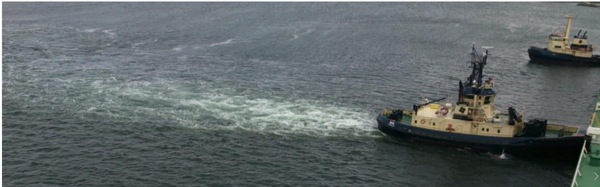
Figur 19. Bogserbåten Bob i Göteborg trycker ett större tankfartyg mot kajen i samband med ankomst och förtöjning. (Foto: Erland Wilske, SSPA).
