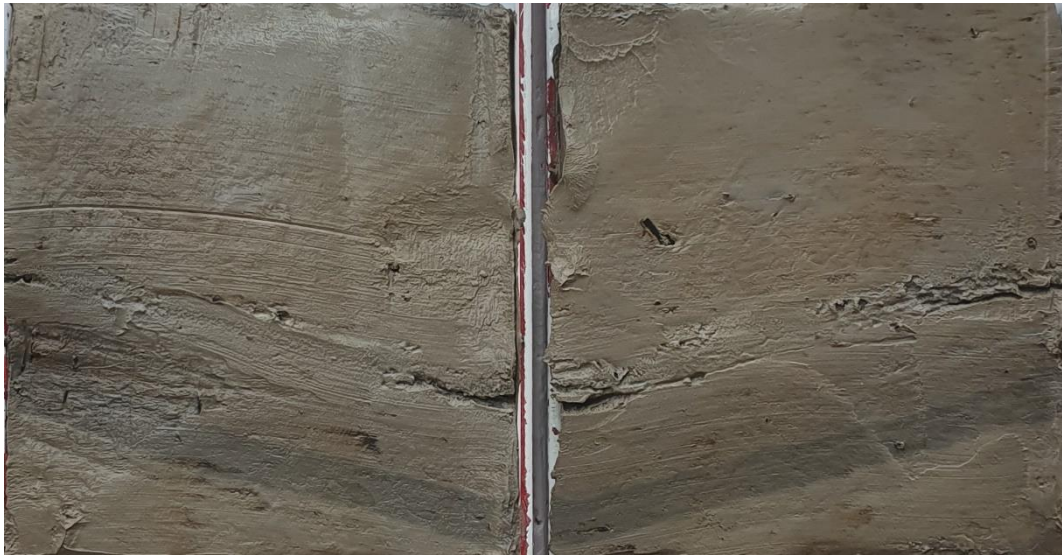
Figur 1 Borrpunkten, 20B01, 1,5 m, Jordprovet i övre delen av mellanhylsan delad longitudinellt provhylsan med id Bjerking 1377.
