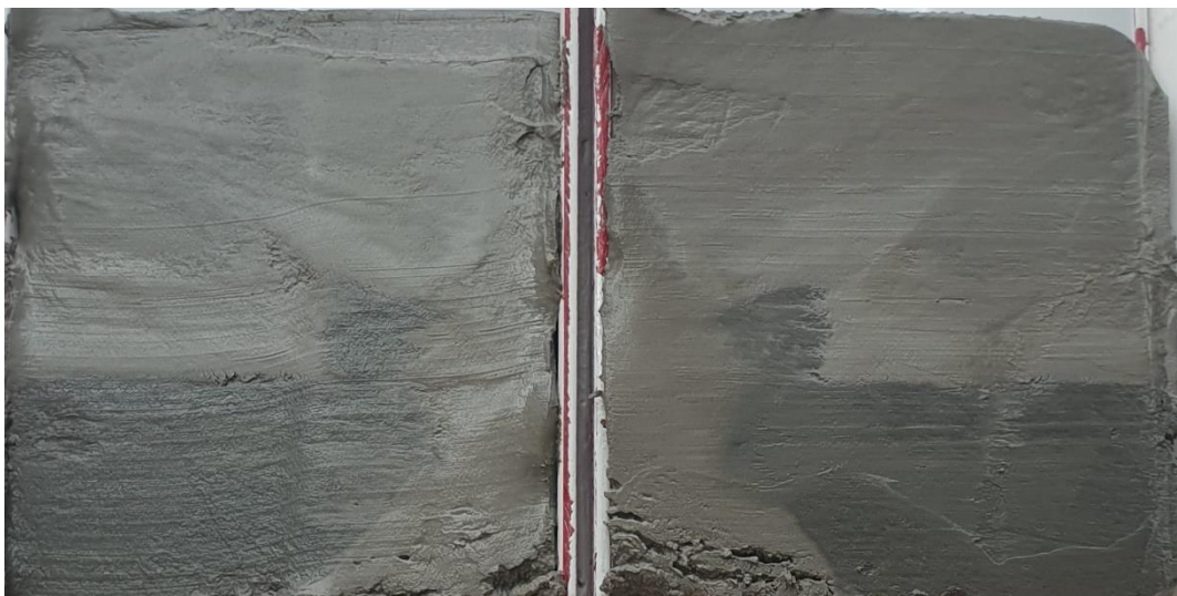
Figur 2 Borrpunkten, 20B01, 2,5 m, Jordprovet i övre delen av mellanhylsan delad longitudinellt provhylsan med id Bjerking 1383.
