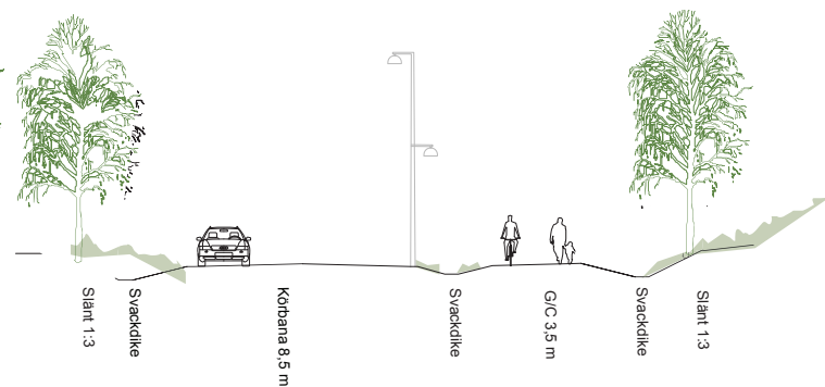
Principsektion för möjlig utformning av väg A med gång- och cykelstråk och viss dagvattenhantering
