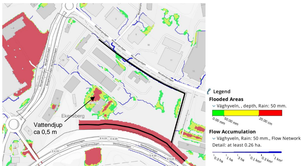
Figur 22. Simulering med avskärande dike (1 m brett, 0,3 m djupt) längs områdets norra och östra gräns samt dike längs södra plangränsen (12 m brett, 3 m djupt). Diken visas med svarta breda linjer.
