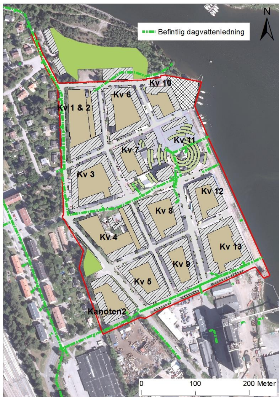
Figur 5. Visar befintligt ledningsnät för dagvatten.
