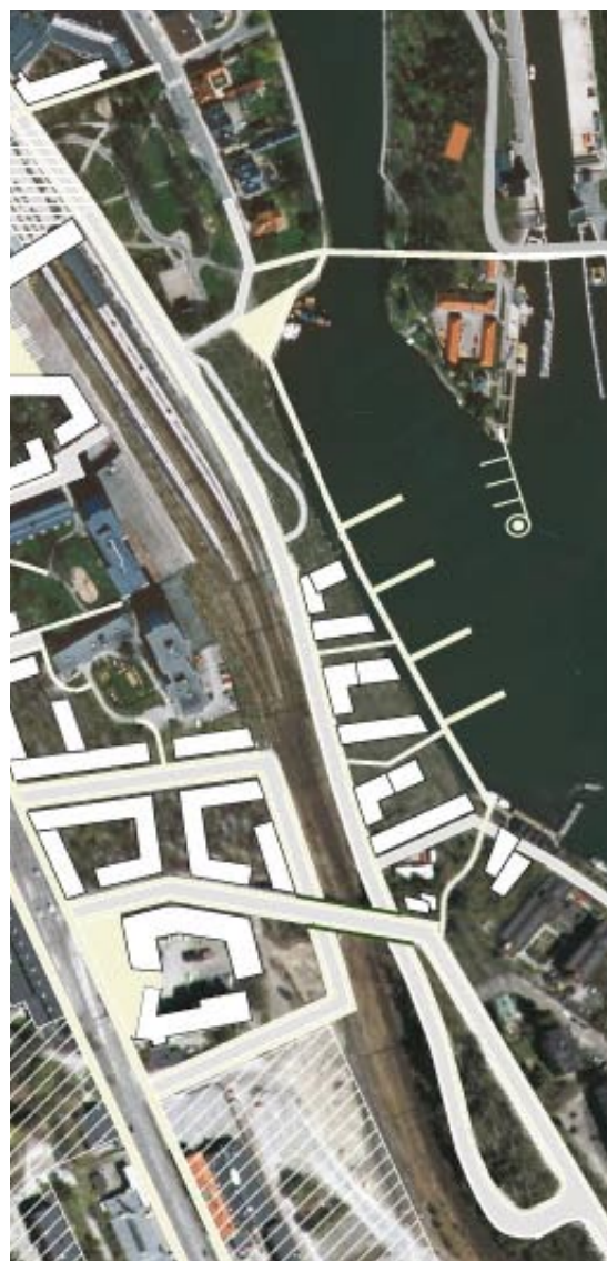
Saltsjögatan flyttas och byggs parallellt med pendeltågspåren genom en ny öppning under Vårdsholmsbron för att sedan ansluta mot Hertig Carls väg.
