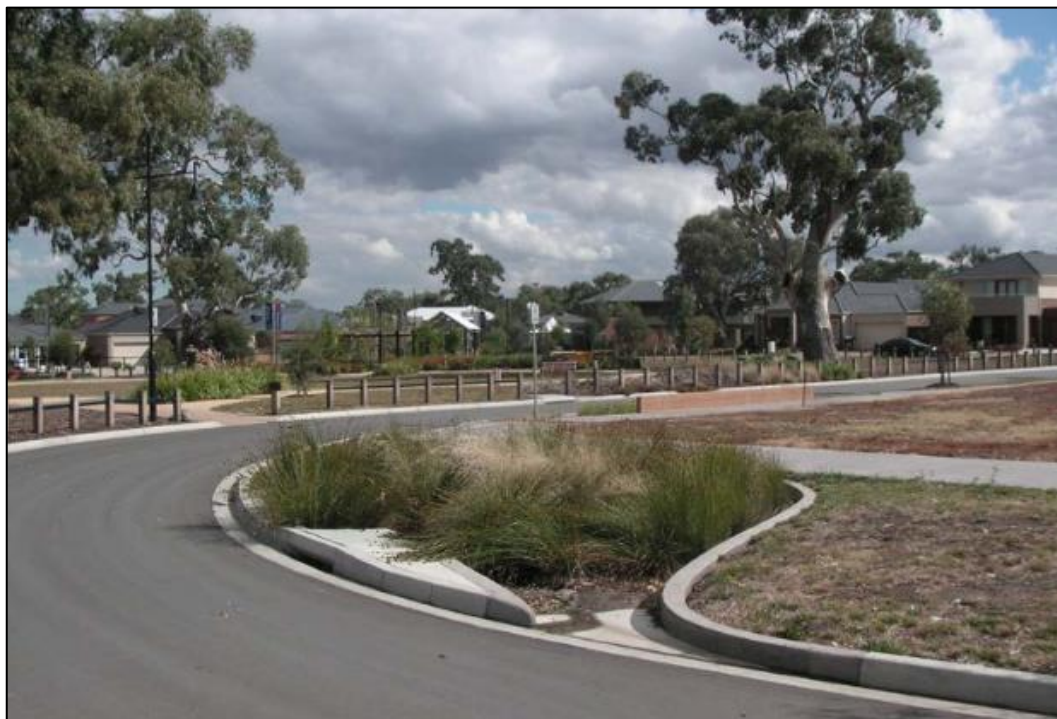
Figur 6-6. Öppning i kantsten, inlopp växtbäddar (Waterbydesign, 2014).
