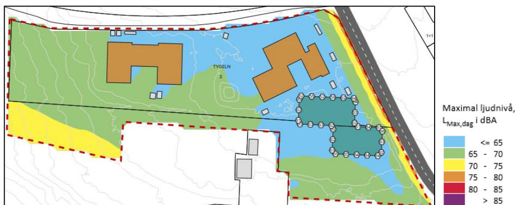
Figur 5. Beräknad maximal ljudnivå 1,5 m över mark för väg- och spårtrafik (maxtimme dag).
