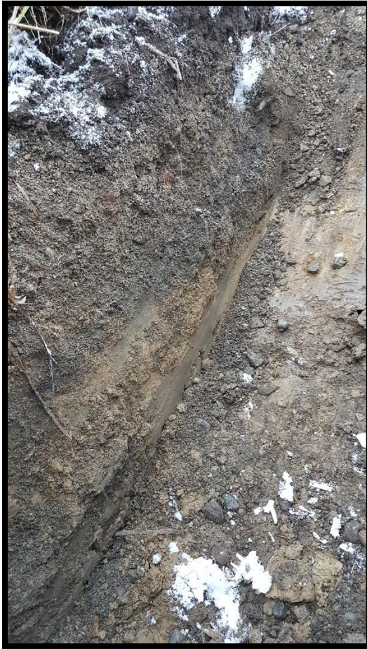
Figur 5. Provgrop 3 (S1). Övre skikt av jord, därunder sand som övergår till lera.
