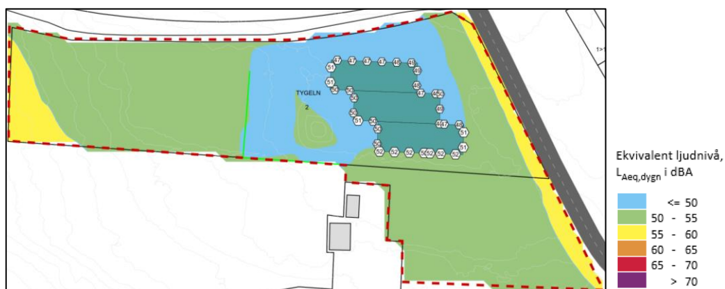
Figur 8. Beräknad ekvivalent ljudnivå 1,5 m över mark för väg- och spårtrafik (dygn). Exempel med en lokal skärmåtgärd (skärmhöjd 2 m öm).
