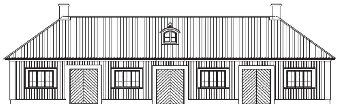
Ritning av byggnad C som ska användas som förlaga för återskapande av byggnad A och B. Bilden visar en principfasadritning av de tre byggnadernas fasadutformning. Framtagen av Nyréns.
