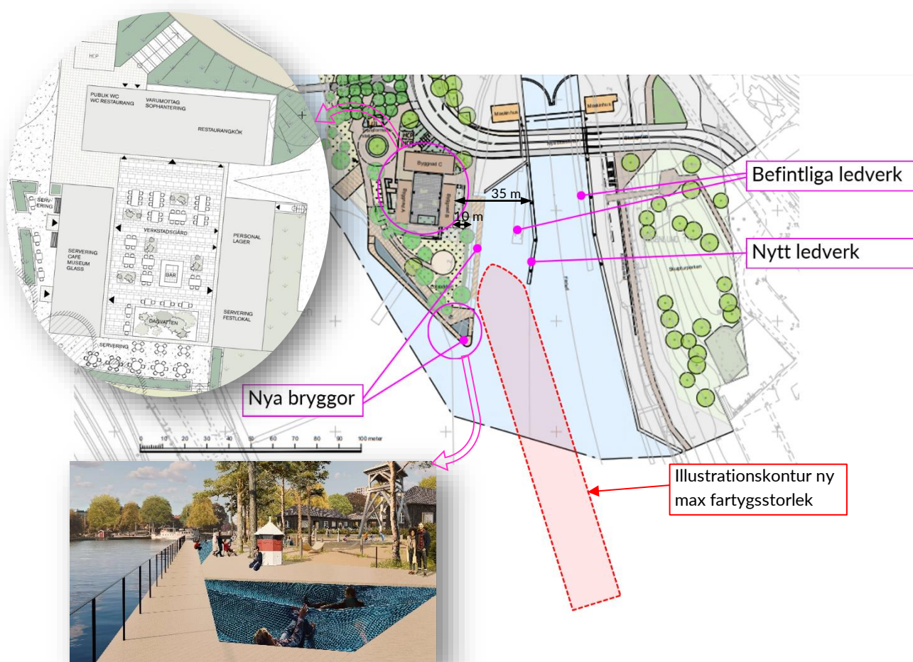
Figur 12. Exempel möjligt påseglingsscenario som uppstått till följd av blackout och förlust av framdrift.
