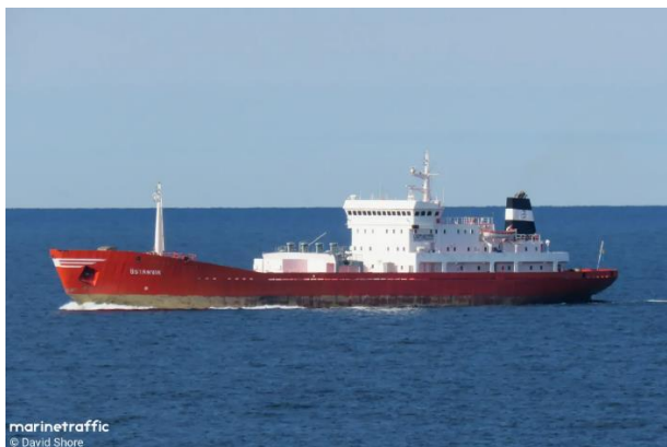
Figur 4. Cementlastfartyget Östanvik har en längd L 107 m och bredd B 16 m. Det byggdes på Sölvesborgs varv redan 1974 och kan i närtid förväntas ersättas av yngre tonnage.
