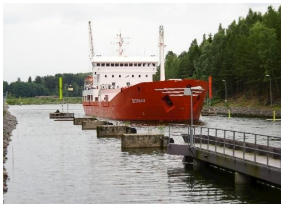
Figur 4. Cementlastfartyget Östanvik har en längd L 107 m och bredd B 16 m. Det byggdes på Sölvesborgs varv redan 1974 och kan i närtid förväntas ersättas av yngre tonnage.
