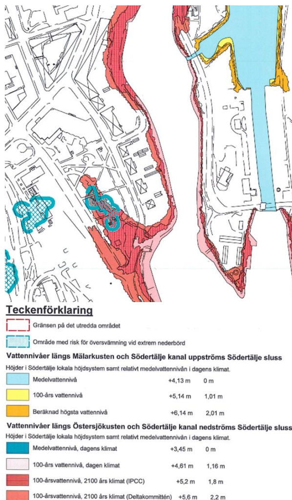
Figur 2. Översvämningsutbredning inom Marens vattenområde samt delar av Södertälje kanal.
