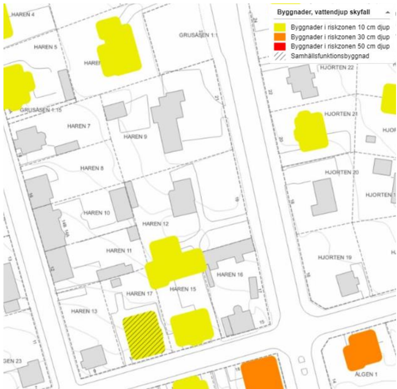
Figur 14 Byggnader i riskzonen (gul färg 10 cm djup) (skyfallskartering, Södertälje kommun)
