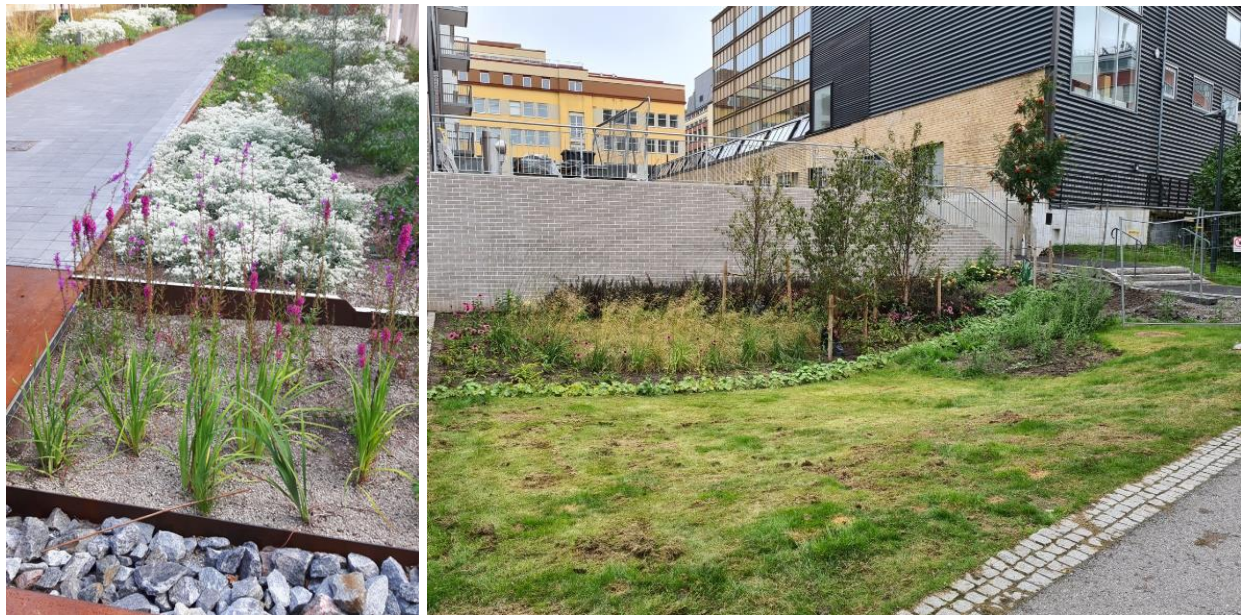
Figur 25 Två exempel på nedsänkta grönytor / planteringar som kan ta emot dagvatten vid regn (N Djurgårdsstaden t.v. och Hammarby Sjöstad t.h.)
