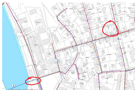
Utlöpp för dagvattenledning som avvattar Haren 9, 12 & 16 (Starkstad 2025)
