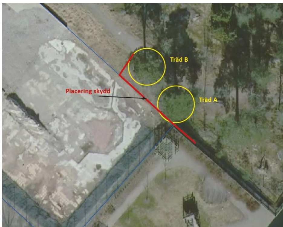
Bedömning av tallar utanför planområdet (markerat i blått) samt förslag på placering av skydd vid byggnation (markerat i rött).
