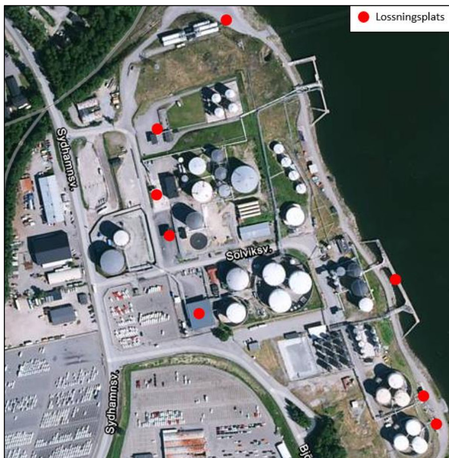
Figur 13.5. Bränslehamnen. Ungefärlig placering av lossningsplatser.
