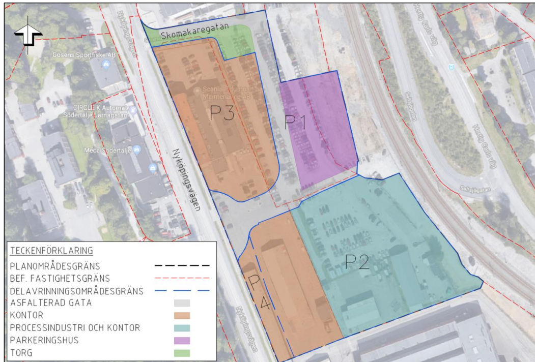
Figur 4.2. Planerad markanvändning inom detaljplaneområdet tolkat enligt planskiss från Södertälje kommun. Framtida delavrinningsområden (P1-P4) avskiljs med blå linje
