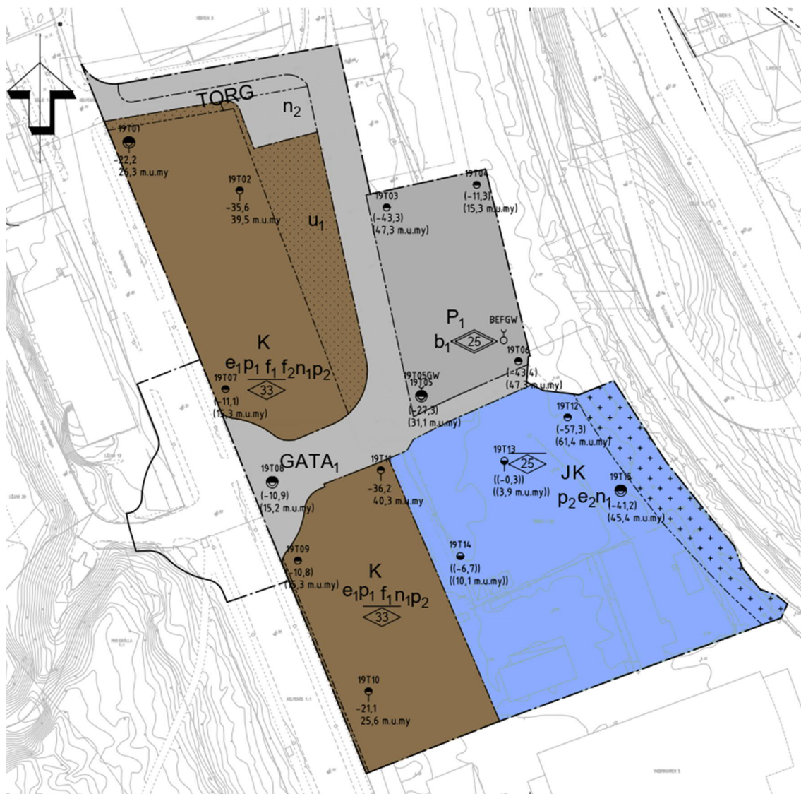
Figur 8.1. Förslagshandling planbestämmelser tillhandahållen av beställaren (underlag 4) samt borrhäckarnas placering. Avslutad nivå och motsvarande m under markytan för sondering enligt svart värde under respektive punkt. Värden utan parentes är stoppnivåer vid hejarsondering. Värden inom parentes är avslutat sonderingsdjup utan erhållit stopp vid hejar- och slagsondering. Värden inom dubbelparentes är avslutat sonderingsdjup vid viktsondering.
