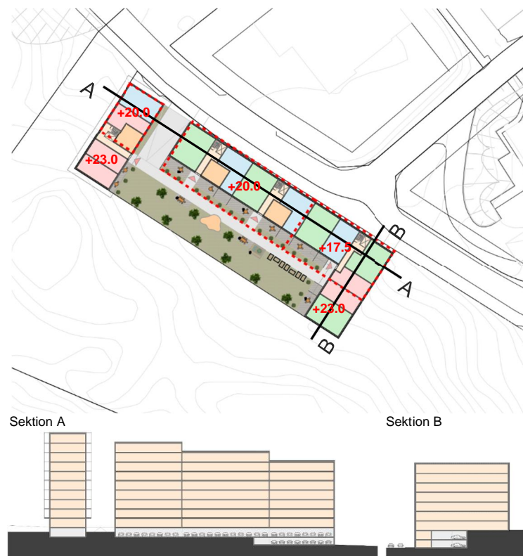
Figur 1. Planerad utformning enligt utredningsskiss daterad 2018-12-13, med preliminära golvnivåer redovisade med röd text.
