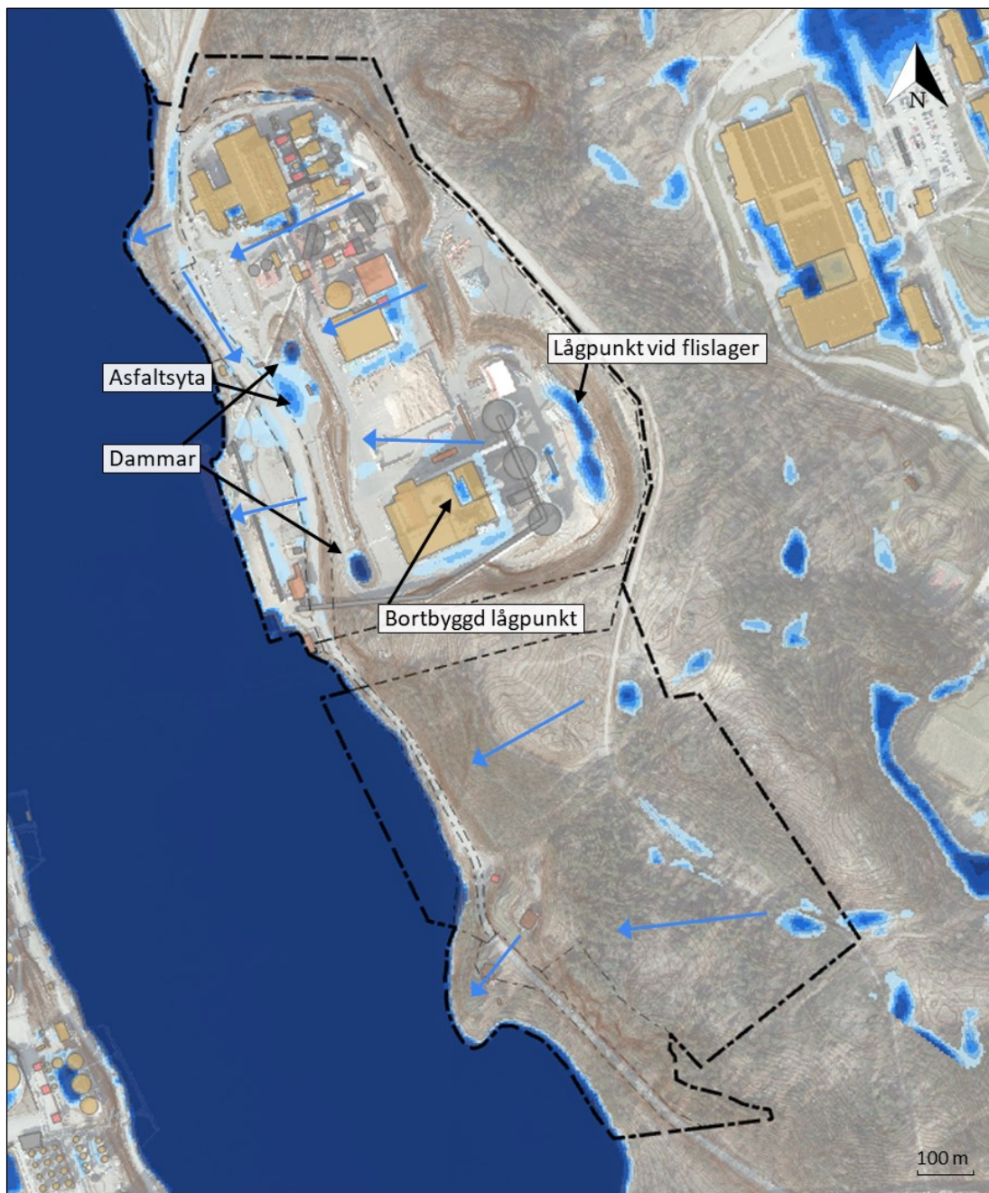
Figur 14. Dynamisk skyfallskartering 2020 för planområdet, maxutbredning vid 100-årsregn (Länsstyrelsen Stockholm; Sweco, 2020). Blå pilar visar flödesriktningar.
