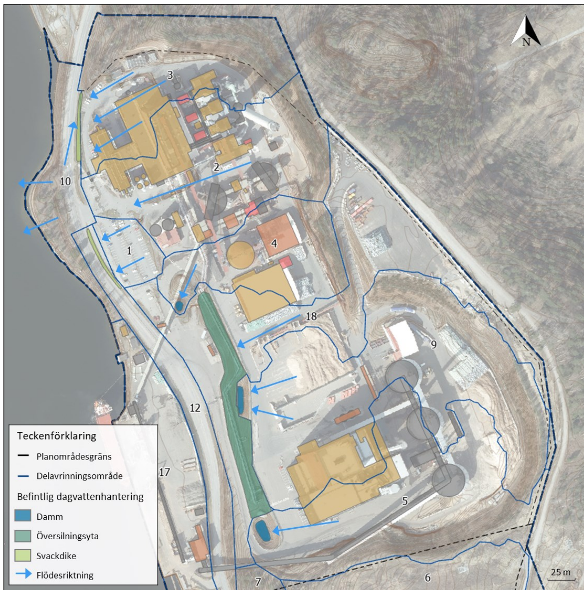
Figur 13. Dagvattenlösningar och flödesriktning för befintliga anläggningar.
