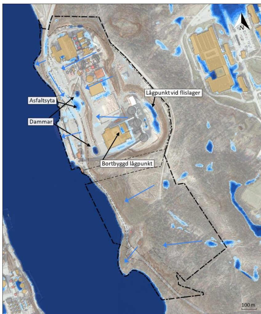
Figur 7.24. Lågpunkter med stående vatten inom utformning av tidigare planområde för befintlig situation vid 100-års regn med klimatfaktor 1,3 (totalt 109 mm regn), där avdrag för ledningsnätets kapacitet har gjort för alla hårdgjorda ytor. Blå ytor visar var vatten ansamlas och blå pilar visar flödesriktningar (Norconsult, 2024).
