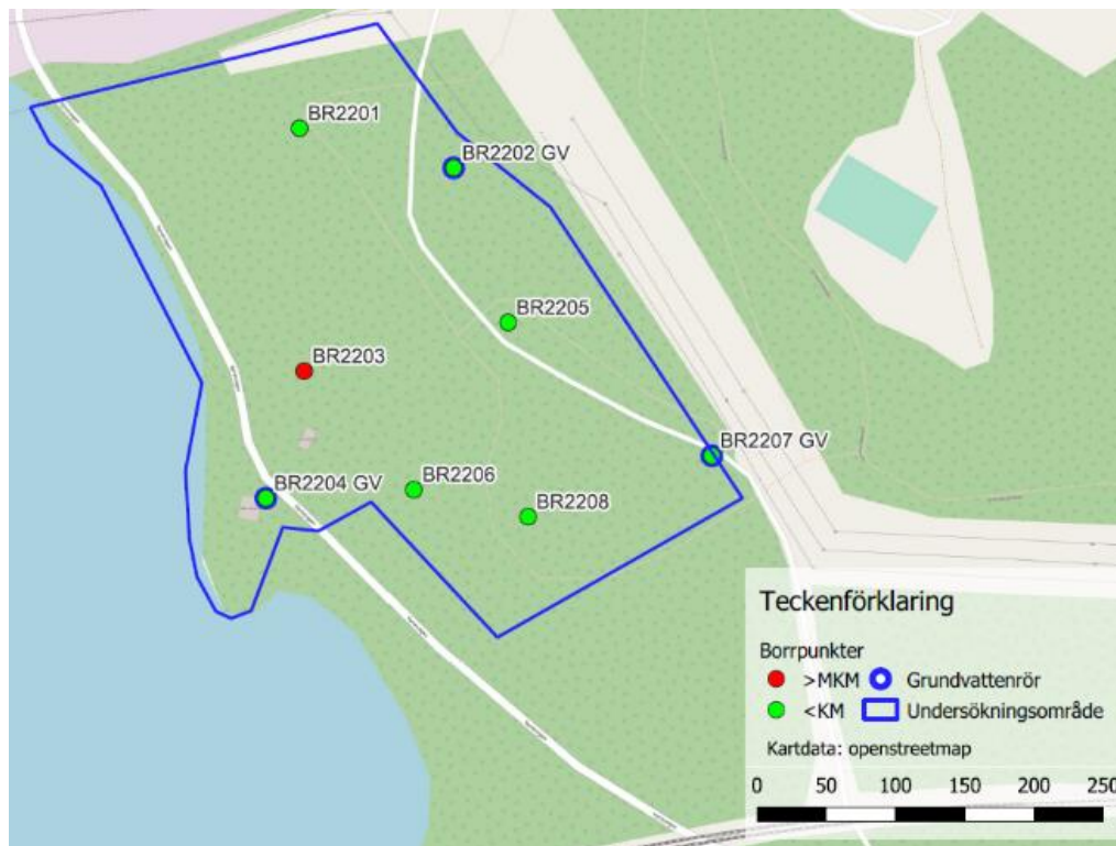
Figur 15 Provtagningspunkter inom översiktlig miljöteknisk markundersökning.
