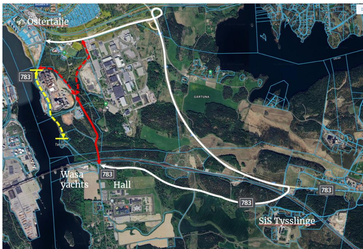
Figur 24 Nynäsvägen föreslås stängas av längs gul sträcka. Trafik föreslås ledas om på breddad grusväg öster om Igelsta-verket, röd linje. Anslutning till befintligt vägnät föreslås ske antingen västerut till Nynäsvägen eller österut till Gärtunavägen via Astraallén, röda streckade linjer ovan. Alternativt leds trafik om via väg 225, vit linje. Lämplig vägsträckning ska utredas vidare i det fortsatta planarbetet.
