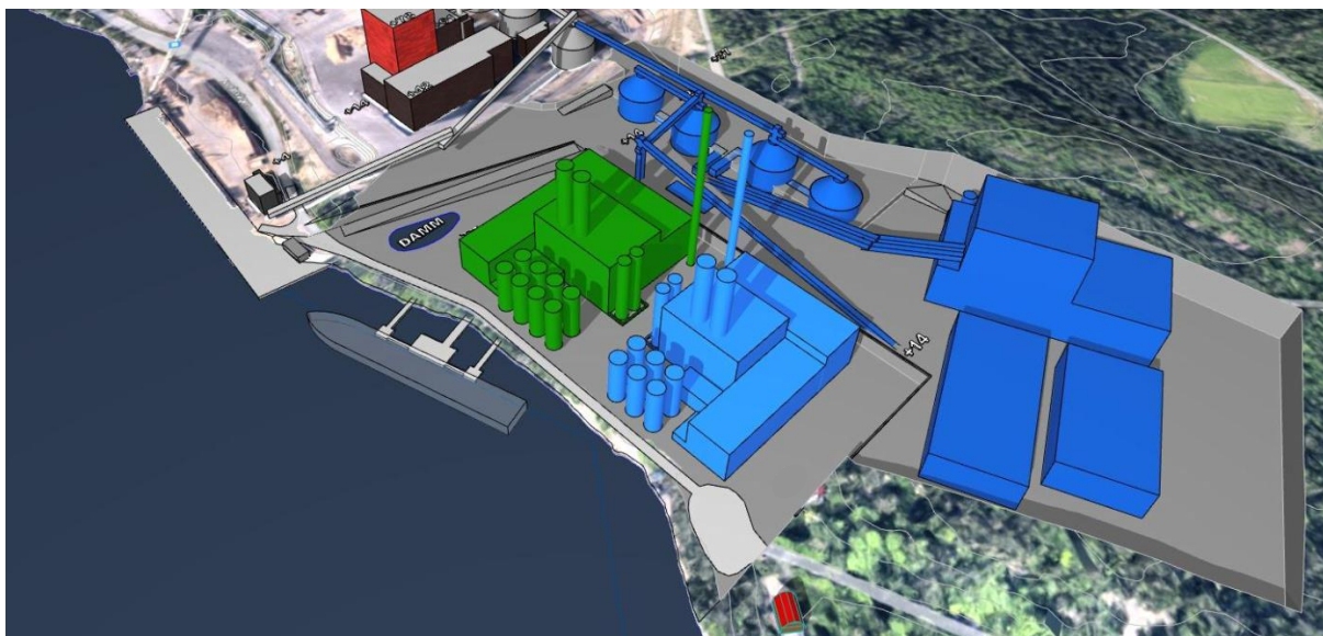
Figur 2. Skiss över planerad utbyggnad av Igelstaverket.
