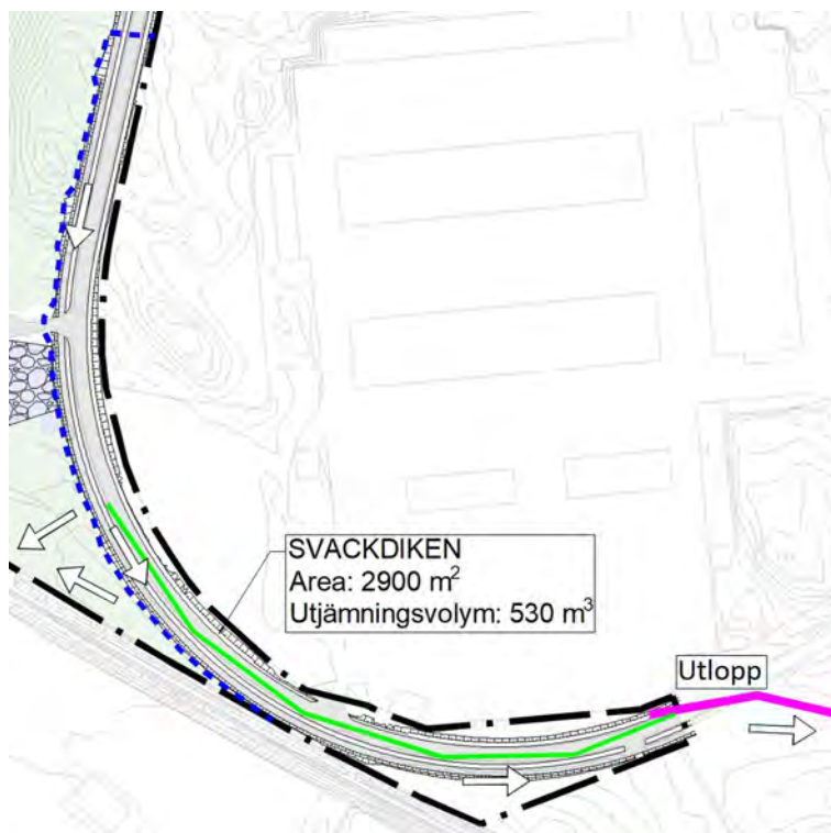
Figur 7:11. Föreslaget reningssteg inklusive anläggningens yta och utjämningsvolym för att ta hand om dagvattnet från vägen i delområdet PLAN Södra S. Området avgränsas från övrigt planområde av den blå streckade linjen
