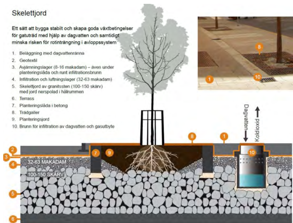
Figur 7:2. Schematisk illustration över plantering av träd i skelettjord (Bildkälla: Stockholm Vatten och Avfall)
