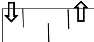
Figur 2. Principskiss som visar damm med mellanväggar, vilket ökar reningseffekten.
