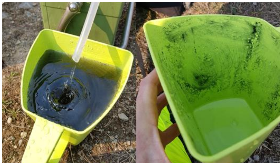
Bild 6. Vid det befintliga stålröret vid "utfyllnaden" noterades lukt av olja och svarta utfällningar.
