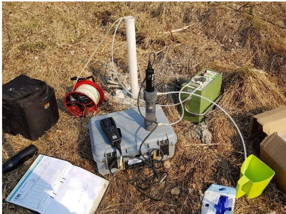
Bild 5. Foto taget den 24 april 2019 under vid grundvattenprovtagning med lågflödesprovtagning, fotot visar grundvattenrör PE19_GV02.
