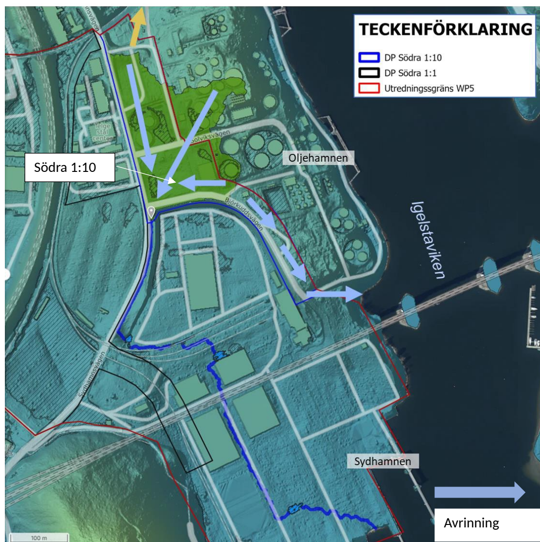
Figur 7, Avrinning inom och utanför planområdet. Karta från dagvattenutredning. Källa: dagvattenutredning, Sweco.
