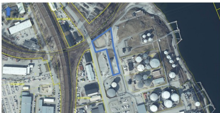
Figur 18, Utredningsområdet har avgränsat till tillkommande stora konstruktioner som kan ha en sättningpåverkan. Utredningsområdet har även avgränsats till närheten av järnvägen.
