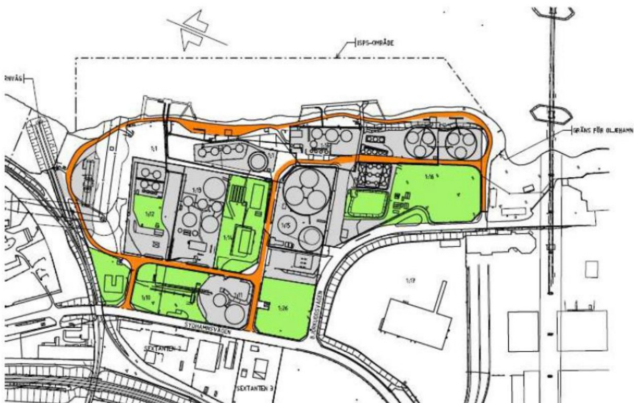
Figur 1, Grönt markerar områden för utökad cisternkapacitet. Gråa områden markerar befintliga depåer och orange interna transportvägar. Bild från riskutredning Södertälje Oljehamn, Cowi, 2014.
