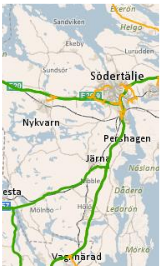
Figur 5.1. Farligt godsleder inom Södertälje kommun. Gröna vägar är primära transportleder och orangea är sekundära.
