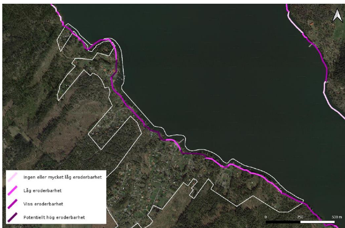
Figur 88 Stränders eroderbarhet. Källa: Översiktlig geoteknisk utredning, Breccia, 2023
