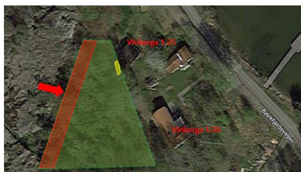
Figur 84 Område i brott markeras med rött, riskområde markeras med grön färg, skyddsvall markeras med gult.
