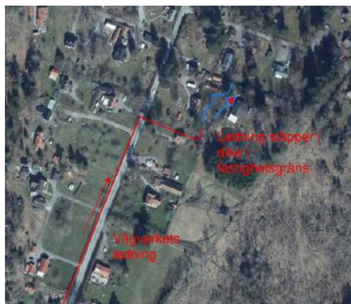
Figur 87 Röd linje visar var Trafikverket leder ut dagvatten över kvartersmark
