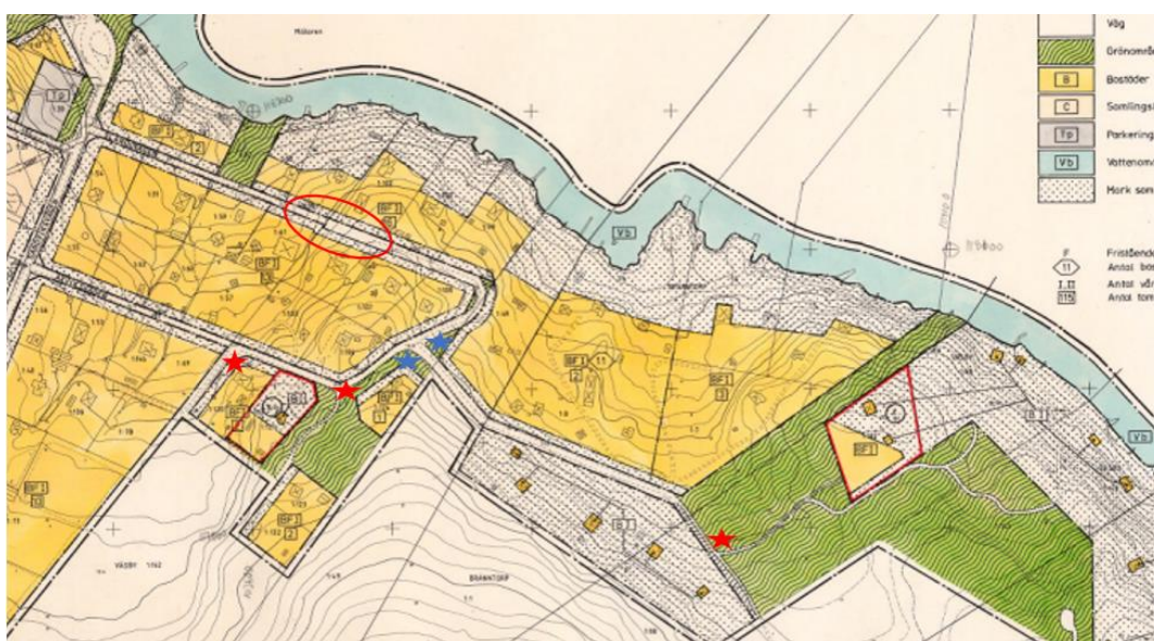
Figur 105 Befintliga uppsamlingsplatser markeras med röd stjärna. Tillkommande uppsamlingsplatser markeras med blå stjärna. Ej genomförd vägdragning markeras med röd cirkel.
