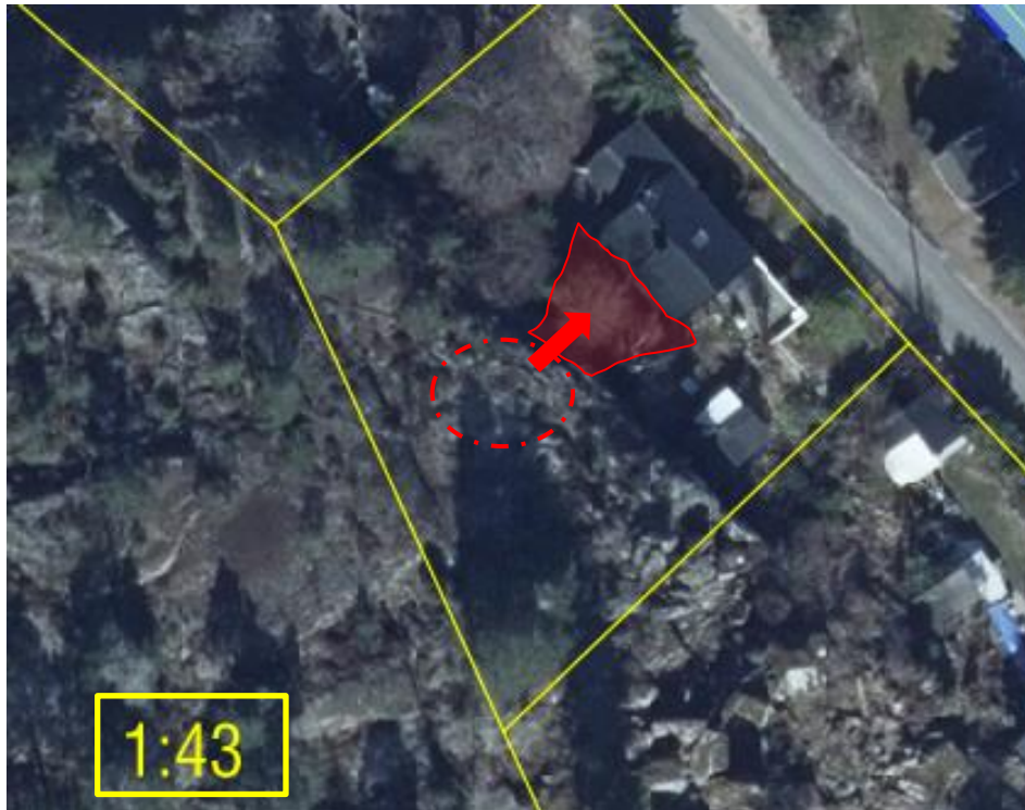
Bild 22: Område med löst bergblock i brant slänt – röd pil = fallriktning
