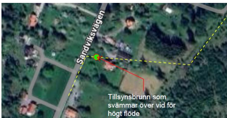
Figur 55 Läge för tillsynsbrunn som svämmas över vid höga flöden
