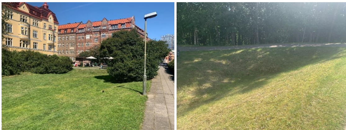
Figur 29. Exempel på skyfallslösningar där en grönyta utformas nedsänkt (Foto: Bjerking AB).
