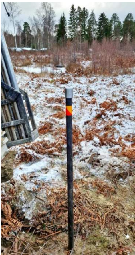
Figur 2. Installerat grundvattenrör, 25B01GVR.
