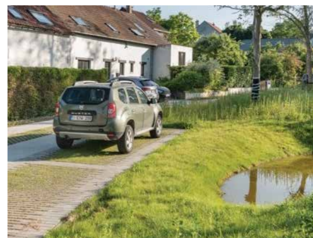
Referens möte med kvartersgata: Mötet med parkrummet bejakas i gatans materialitet. Nivåhantering, öppen dagvattenlösning och vegetation bildar rumslig gräns i Overjise, Belgien. Arkitekt: Sweco. Foto: Okänd.
