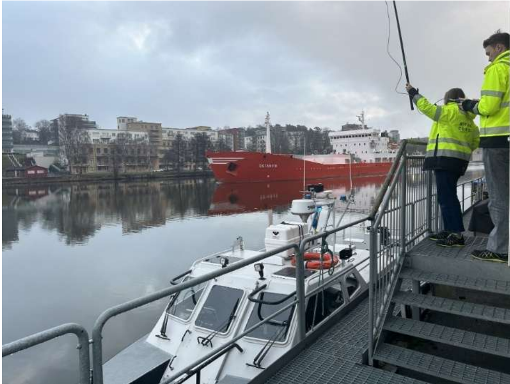
Figur 4 Bullermätning av fartyget M/S Östanvik, vid passage utanför Kustbevakningens station inom planområdet.
