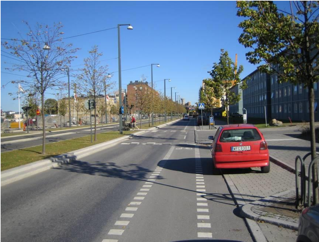
Figur 4. Figuren visar att träden till höger, som växer i skelettjord och får dagvatten, fortfarande har gröna blad jämfört med de träd som växer till vänster där det inte är skelettjord.
