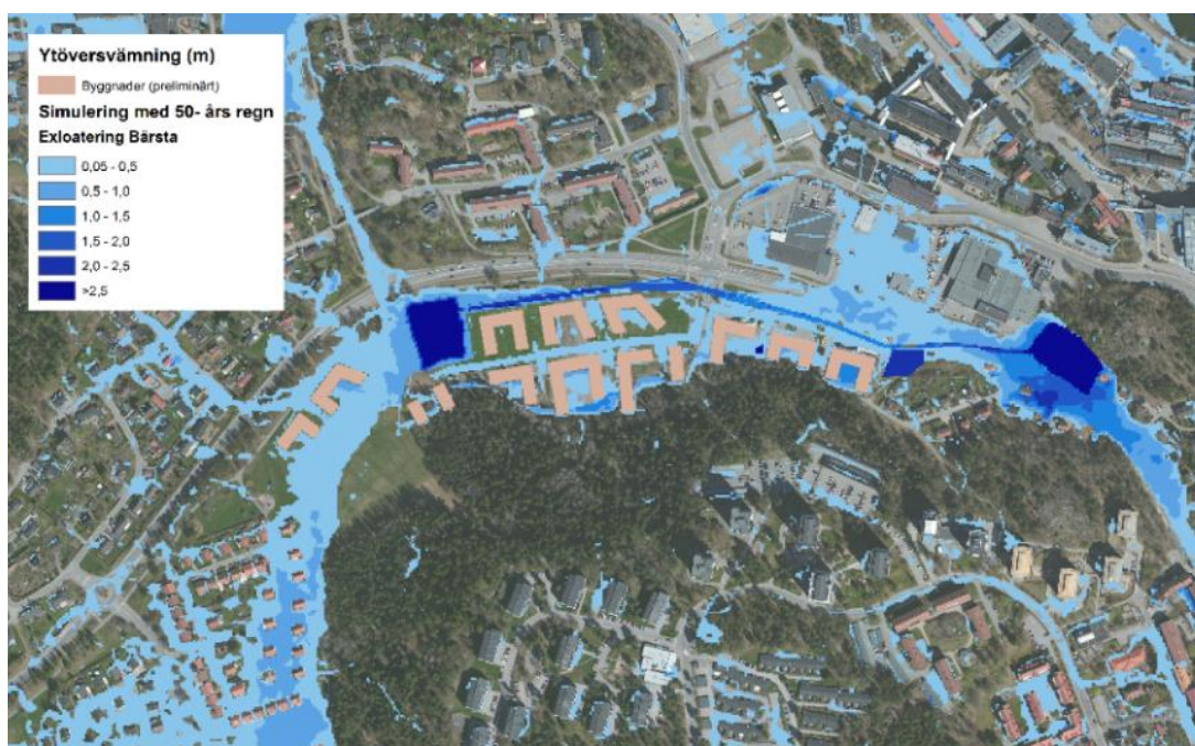
Figur 14. Karta över simulerad utbredning av ytöversvämning vid ett regn med återkomsttid på 50 år med 12 timmars varaktighet vid och kring Bårstafältet. Vid denna simulering har ingen hänsyn till infiltration i området tagits. Kartan visar situationen efter exploatering av Bårstafältet med föreslagna magasin enligt Figur 11.
