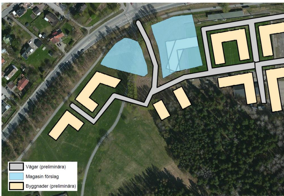
Figur 12. Exempel på omfördelning av magasinvolym i det västra magasinet. En sådan fördelning av volymen kan exempelvis bli aktuell om de geotekniska och hydrogeologiska förhållandena inte tillåter erforderligt djup i magasinet.
