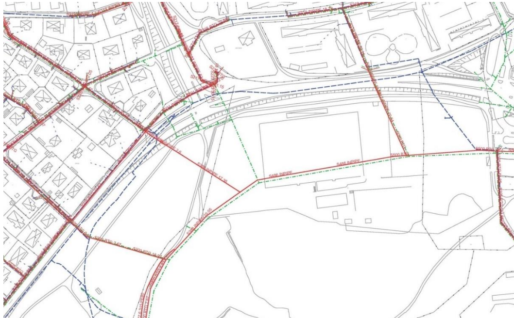
Figur 8. Karta som visar VA-nätet i området. Gröna ledningar är dagvattenledningar, röda är spillvattenledningar och de blå är vattenledningar (Telge).
