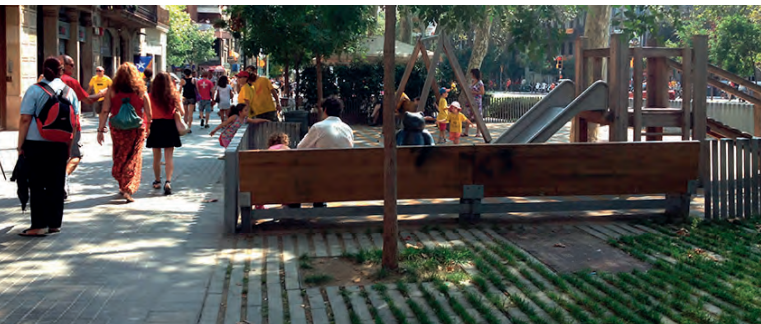
Exempel på urbant stråk med platser för barn längs med stråket. En zon är för rörelse och en för vistelse. Notera att vistelsezonen också har anpassad markbeläggning för ökad permeabilitet.
