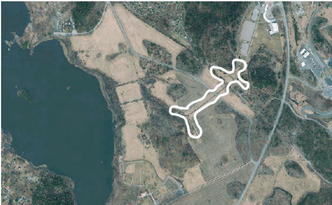
Ungefärlig utbredning för ny våtmark i planområdets södra del som syftar till att fördröja och rena dagvatten
