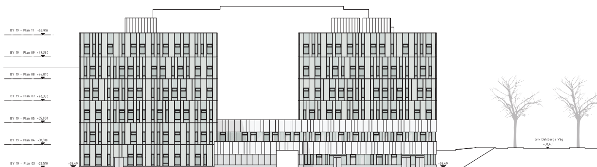
Sektion genom den nya bebyggelsen och Erik Dahlbergs väg (till höger). Den lägre delen mot gatan är möjlig att bygga på till 6 våningar.
