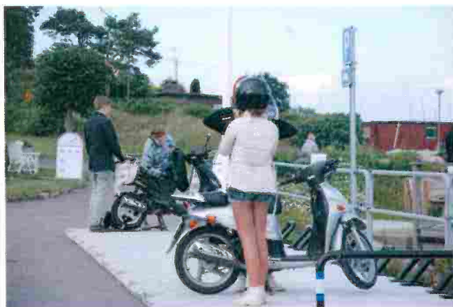
Figur 3-7 Mopedparkering på mobil betongplatta som lyfts på marken. Motsvarande lösningar finns för cykelparkering, med och utan väderskydd. Källa: P-Qlip
