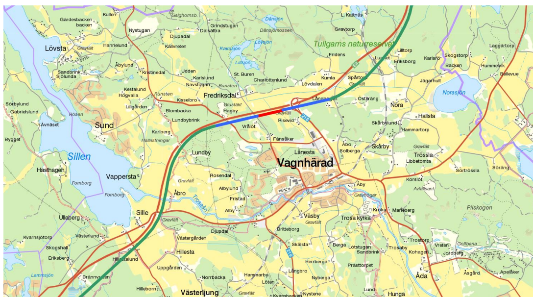
Figur 19 - Alternativ A , Dragning förbi Vagnhärad/Trosaåns dalgång med stationsläge markerat i rött, rakspår med blått och övrig järnvägssträckning med grönt.
