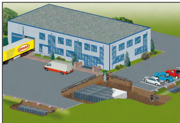
Figur 18. Exempel på utjämningsmagasin bestående av dagvattenkassetter. Illustration: Uponor
